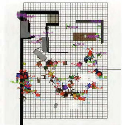
Anhand eines Computermodells werden zunächst die Bahnen und Kollisionen der Einrichtungsobjekte analysiert
